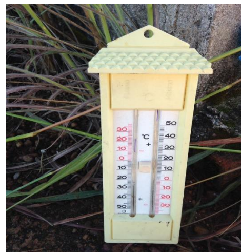
FIGURAS 4 e 5 – Termômetro digital acoplado ao globo negro e termômetro de ambiência analógico, respectivamente.
