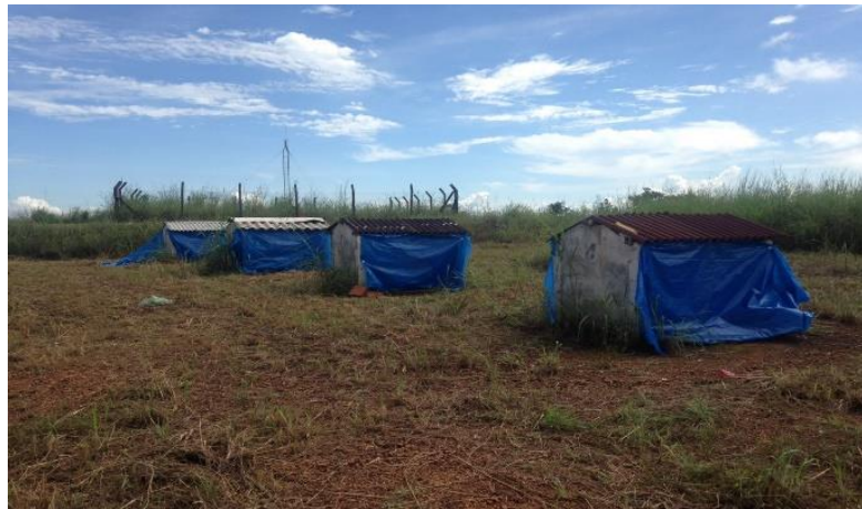
FIGURA 3 – Abrigos individuais, cobertos nas laterais por lona, com quatro tratamentos: FVB - telha de fibra vegetal com pintura reflexiva, FTP – telha de tetra pak industrializado, FV - telha de fibra vegetal e FVF - telha de fibra vegetal com forro interno de tetra pak.
