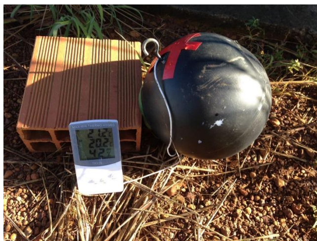
FIGURAS 4 e 5 – Termômetro digital acoplado ao globo negro e termômetro de ambiência analógico, respectivamente.
