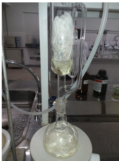
Figura 1. Extração de óleo de baru pelo método de Soxhlet.
