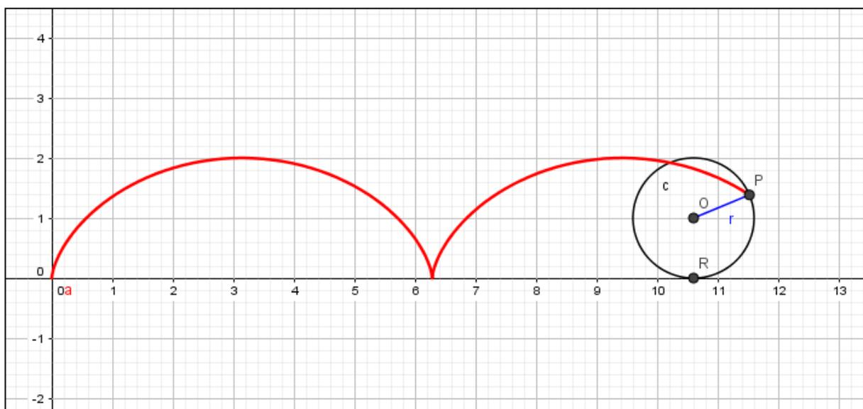
**Figura 4:** Cicloide gerada pelo software geogebra.
