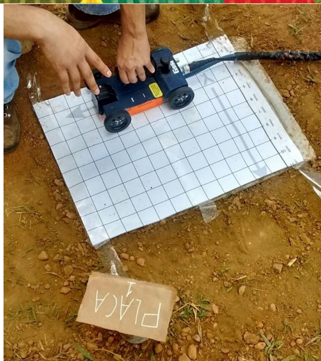
Figura 5 - Processo de aquisição das linhas para leitura com o GPR (fonte própria).
