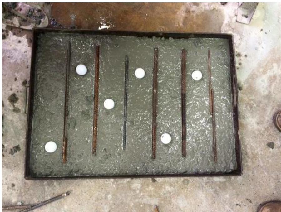
Figura 2- Vergalhões e bolas de tênis de mesa inseridos na placa experimental (acervo do autor).
