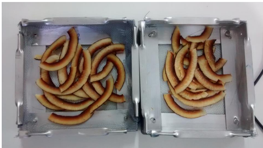
Figura 1 –Polpa do coco em tiras de chips após a secagem em estufa de convecção forçada de ar sob as temperaturas de 50, 60, 70 e 80°C \pm 1°C, até seu equilíbrio higroscópico.
