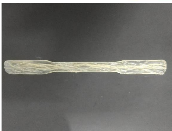
Figura 2: Compósito reforçado com 1% de Fibra Sisal
