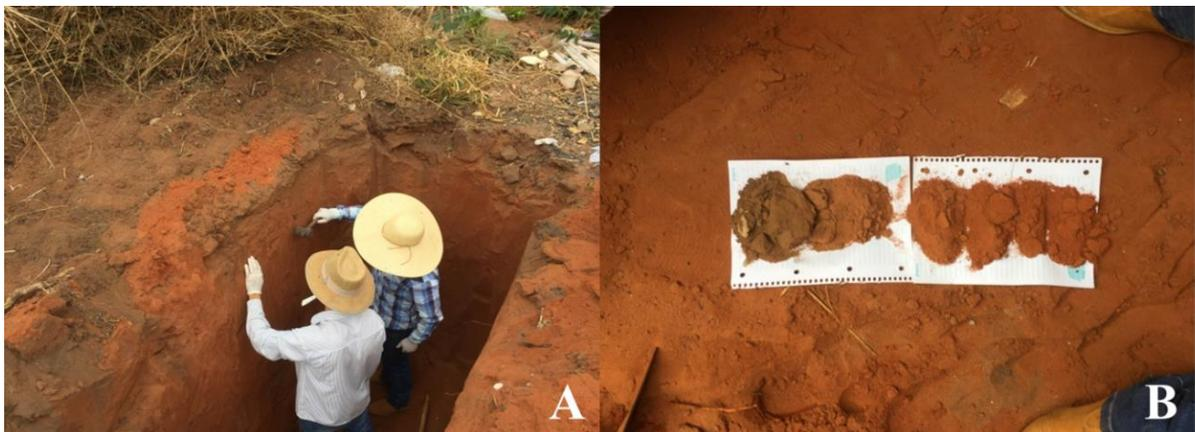
**Figura 1.** A. Caracterização de horizonte utilizando martelo de borracha e canivete. B. Uso de papel branco para auxílio na caracterização dos horizontes do solo.
