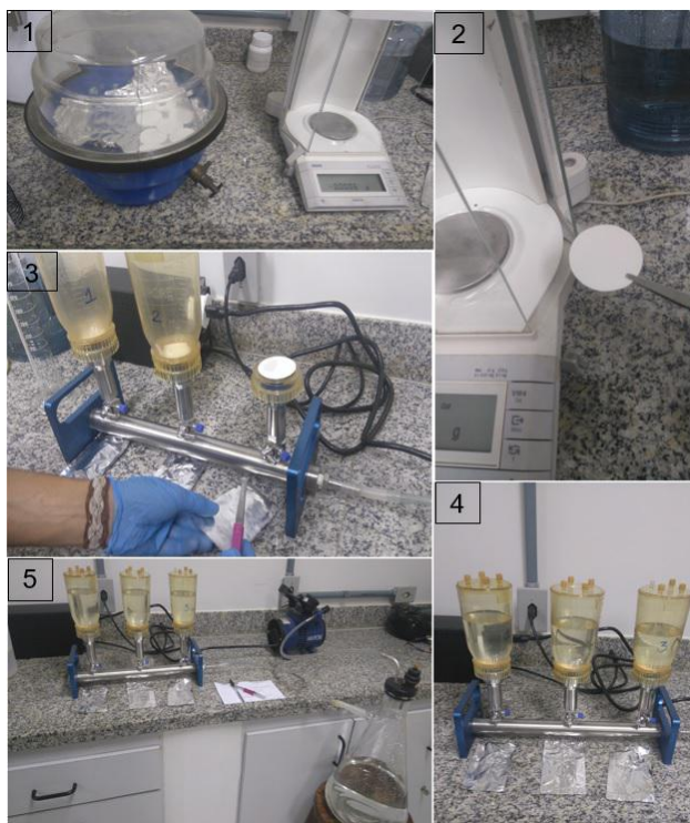
Figura 3 - Equipamentos utilizados na filtragem: dessecador (1), balança de precisão (1 e 2), sistema de filtragem (3 a 5).
