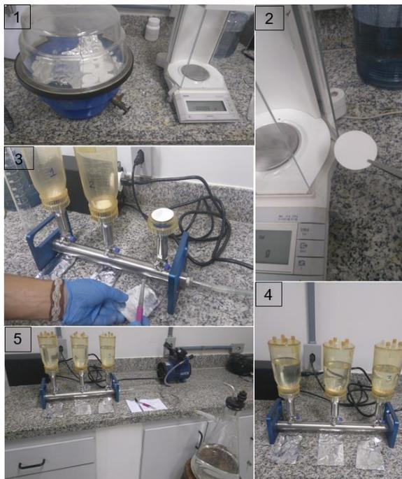
Figura 1 - Equipamentos utilizados na etapa Laboratorial. dessecador (1), balança de precisão (1 e 2), sistema de filtração (3 a 5).
