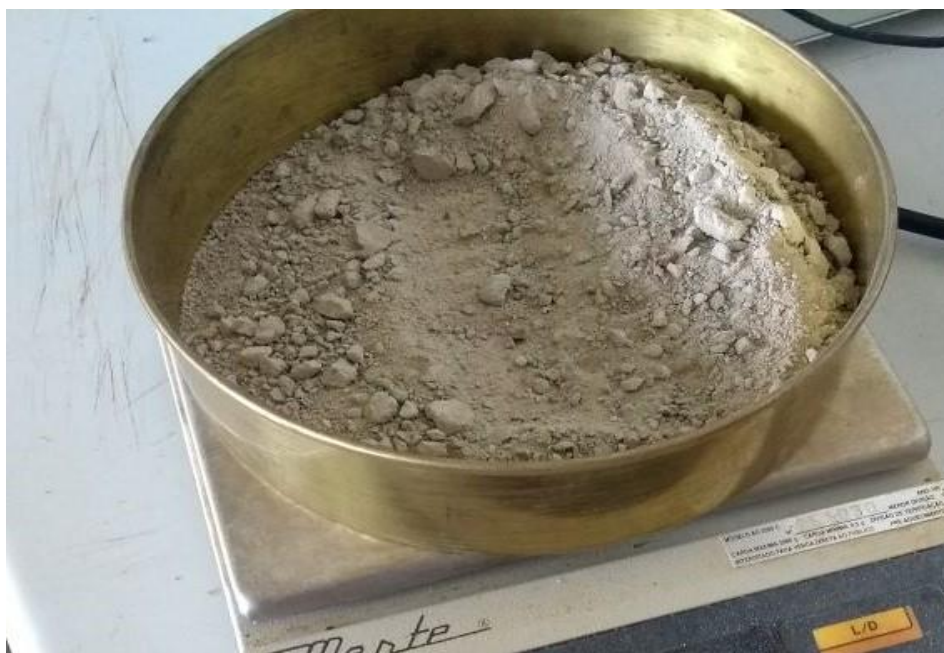
Figura 1 - Amostra de resíduo da fabricação de telhas de cimento, já triturado, sendo pesada.
