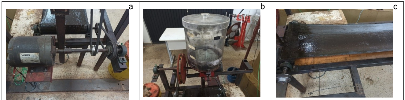
Figura 1 - (a) Sistema utilizado para acionar a esteira e o disco dosador de sementes do reservatório, (b) reservatório de sementes e (c) esteira transportadora.
