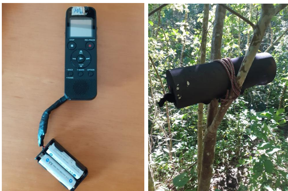
Figura 1. Gravador com adaptação para receber pilhas médias (AA) (Esquerda) e tubo onde esse gravador era mantido em campo (Direita).
