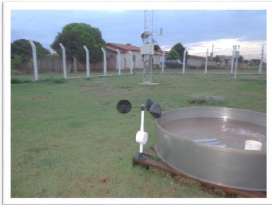
Figura 2 – Tanque Classe A.
