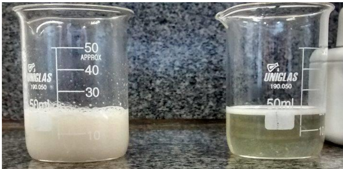
Figura 1. Foto do procedimento: o primeiro frasco contém mistura gelatina aquosa mais creme com ativo demonstrando mudança na coloração; o segundo frasco contém apenas gelatina aquosa
