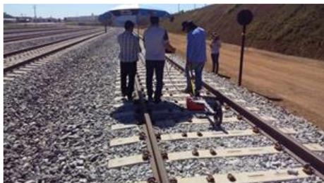
Figura 1. Fotografia evidencia a aquisição de dados de GPR com o sistema SIR3000 acoplado a uma antena blindada de 900MHz.
