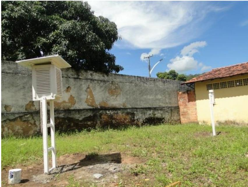
Figura 3: Estação Meteorológica e o pluviômetro de PVC montados.
