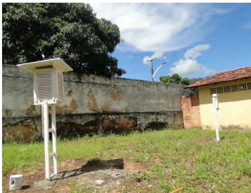
Figura 3: Estação Meteorológica e o pluviômetro de PVC montados. Fonte: Romário Rosa de Sousa (2015).
