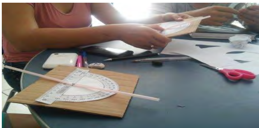
Figura 3: Teodolito construído pelos alunos
