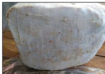
Foram realizadas duas tentativas de amostragem com o barrilete Denison para comparar com a coleta por bloco indeformado em poço. No entanto, ambas falharam: a primeira devido ao contato do solo com a água da perfuração e a segunda devido à sobrecarga do motor elétrico da sonda devido à resistência do solo. Isso impediu os ensaios laboratoriais planejados.
