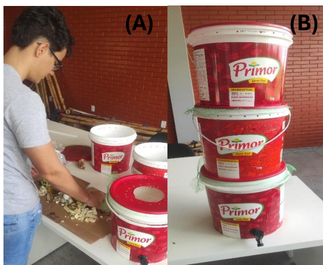
Figura 2: Montagem da Composteira (A) e composteira por balde (B).
