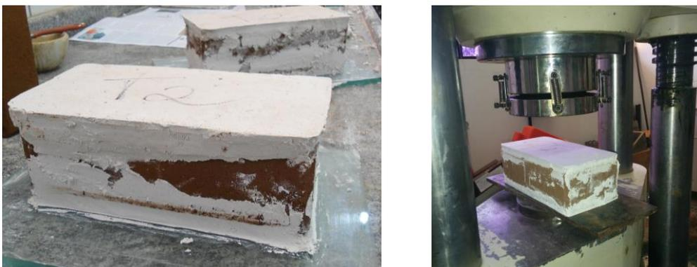
**Figura 1:** Tijolos preparados com capeamento para análise de resistência à compressão.
