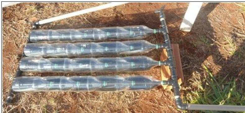
Figura 3. Coletor solar montado e em funcionamento.
