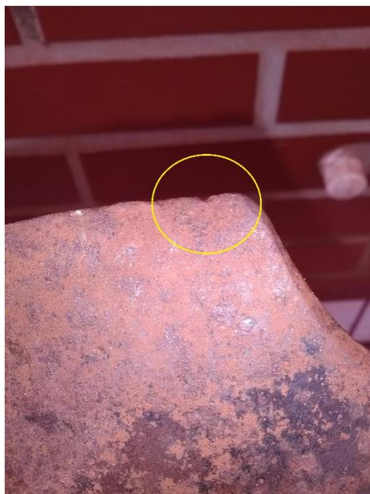
**Figura 2-** Ranhura no disco temperado em destaque.
