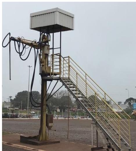
**Figura 2:** Sonda pneumática fixa.
